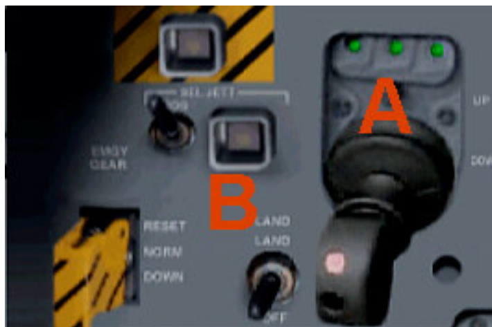
A – Fahrwerkshebel B – Landelichtschalter
