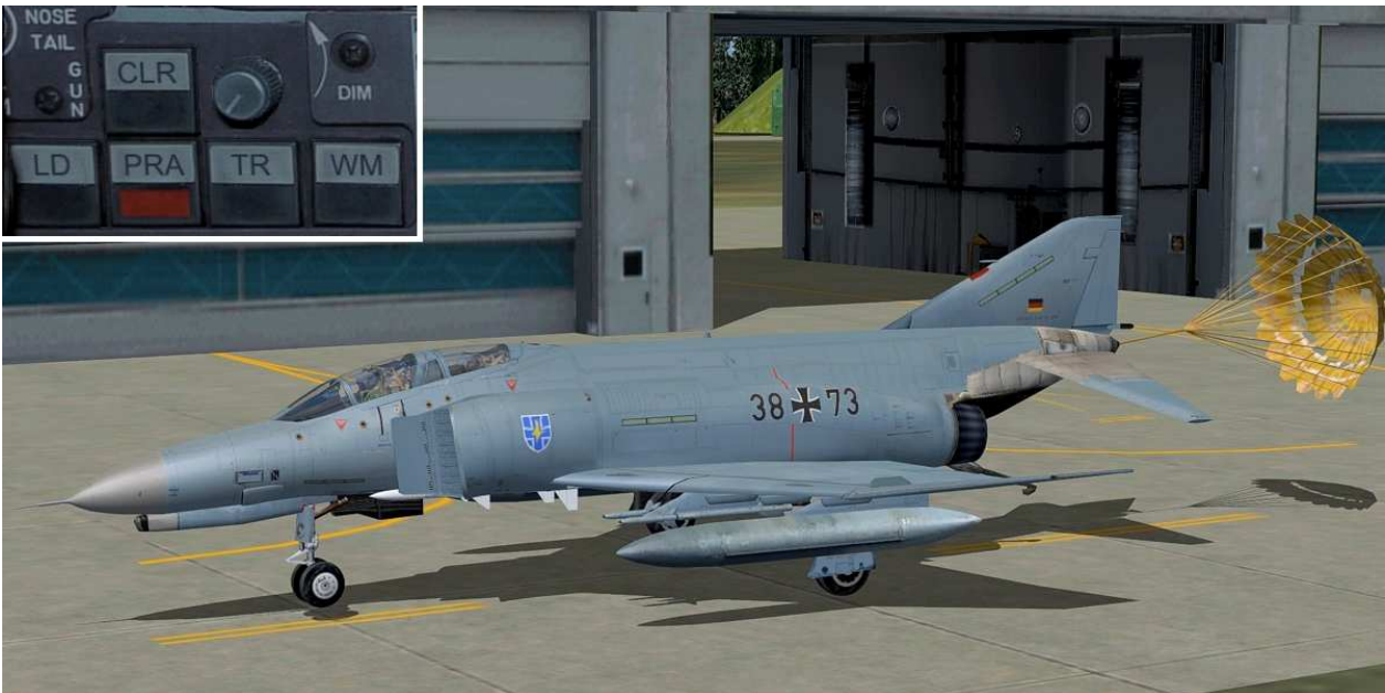
PRA – Ausfahren des Bremsfallschirm ( Parabrake ) bei Bodenberührung
